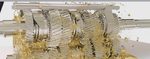
トランスミッション内のオイル挙動解析
