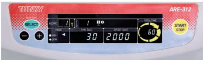
「SELECT」「+」「-」の3つのボタンで、ステップ、攪拌・脱泡モード、時間、回転数の設定ができ、最大 20 のレシピを登録しておく事が可能です。
